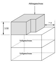
a ≥ 3.50 m Minimales Mass für die Zurückversetzung des Attikageschosses gegenüber der Fassade des darunterliegenden Vollgeschosses.
