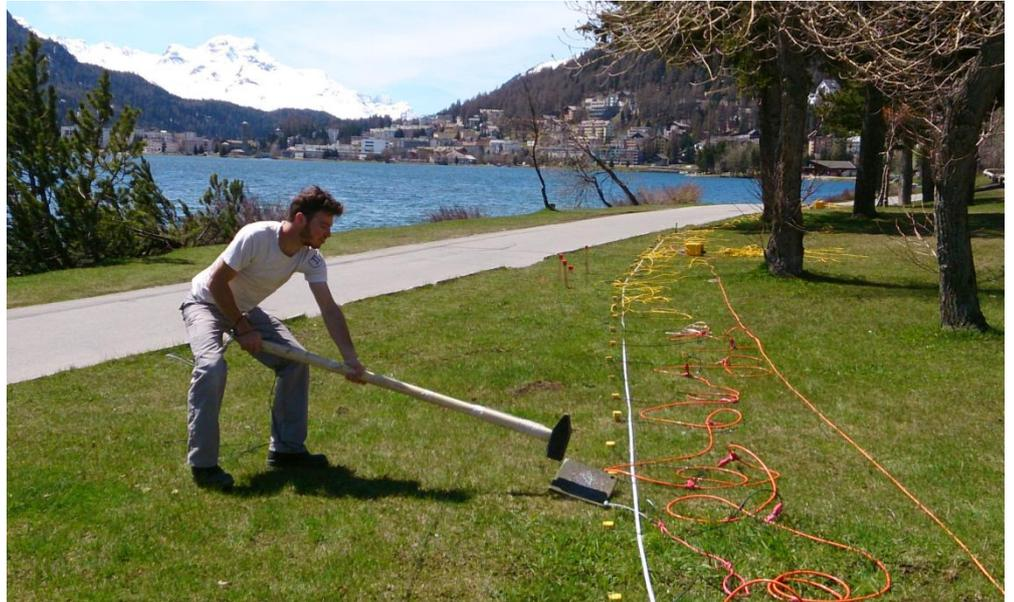
Abb. 3: Seismische Quelle: Schläge mit dem Vorschlaghammer auf eine Stahlplatte.
